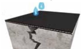
Rissüberbrückende Abdichtung mit Armierungsgewebe: Das Gewebe trennt die obere Abdichtungsschicht vom Riss und hilft maßgeblich, dem permanenten Wasserdruck zu widerstehen.
