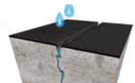
Elastisch, aber nicht rissüberbrückend: kann dem permanenten Wasserdruck nicht widerstehen.
