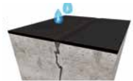
Rissüberbrückende Abdichtung: In diesem Fall wird durch die Schichtstärke und die Elastizität der Abdichtung dem permanenten Wasserdruck standgehalten.
